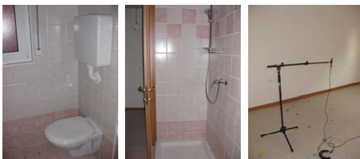
Figura 8 – Palazzina D, immagini di wc e doccia di uno dei bagni ed esempio di posizionamento del microfono per una misura in campo diffuso
