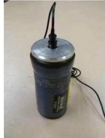
Figura 5 - Calibratore acustico di classe 1 con adattatore per microfono di tipo Lavalier.
