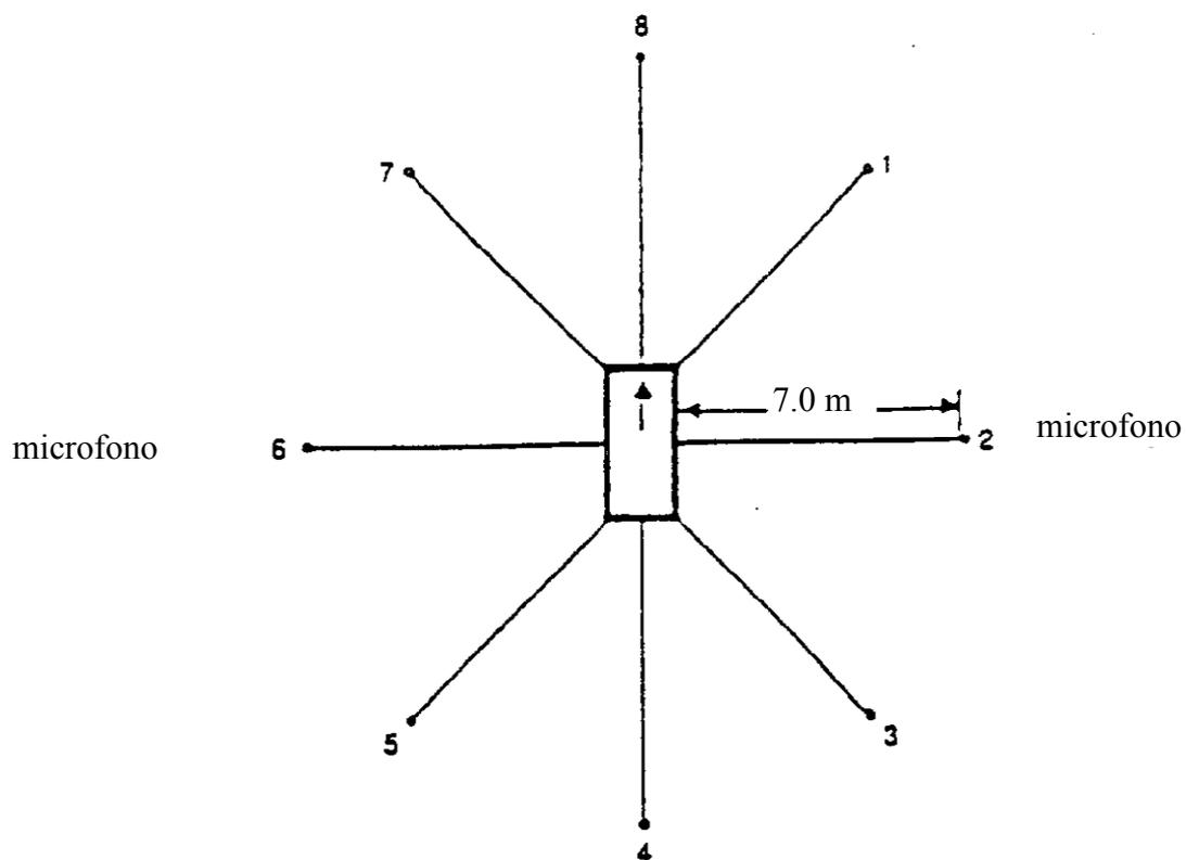
La misurazione va effettuata a veicolo fermo in conformità alla Figura 1, utilizzando 2 posizioni del microfono a una distanza di 7 m dal perimetro dei veicoli e a un'altezza di 1,2 m dal suolo.
