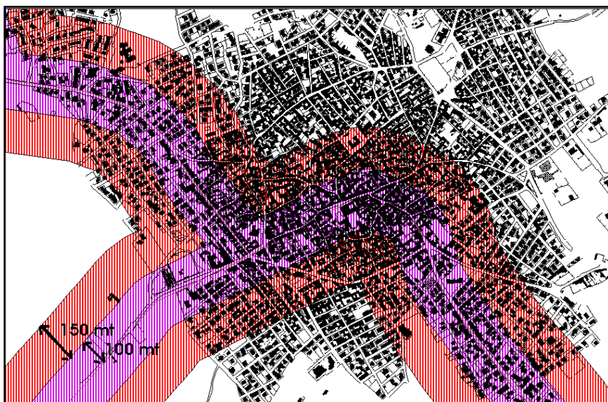
Figura 5.9: rappresentazione delle fasce di pertinenza su GIS
