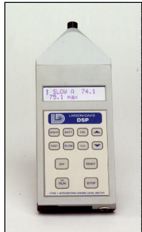
Figura 1: fonometro integratore in classe 1. Lo strumento rappresentato è in grado di misurare il Livello equivalente in dB(A). (Larson & Davis)
