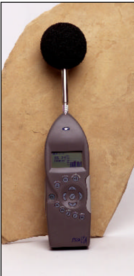
Figura 2: Fonometro analizzatore integratore in classe 1. Con lo strumento rappresentato è possibile eseguire l'analisi in frequenza parallela in banda di ottava (16 Hz - 16 kHz) oppure in banda di un terzo di ottava (12.5 Hz - 20kHz). (Larson & Davis)
