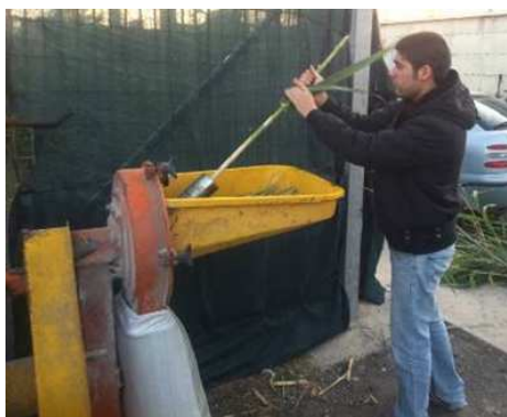
Figura 3 – Operazione di triturazione.
