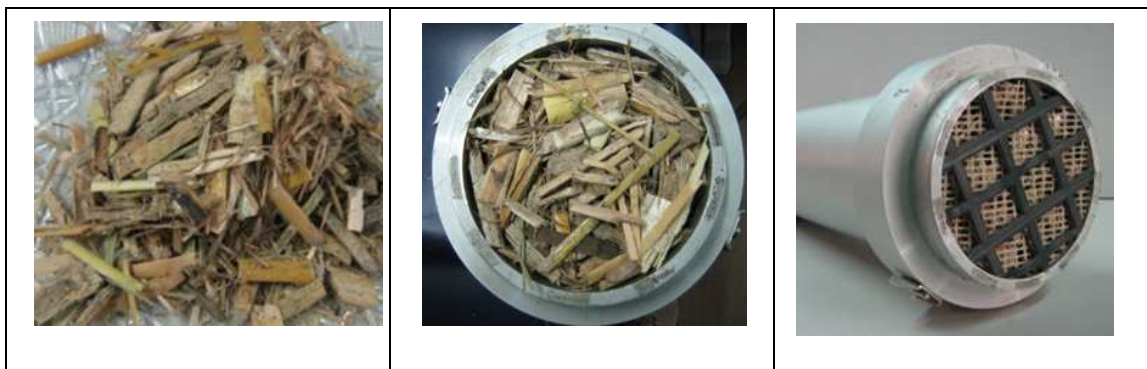
Figura 5 – Fasi preliminari per la misura del coefficiente di assorbimento ad incidenza normale mediante il tubo di “Kundt”.
