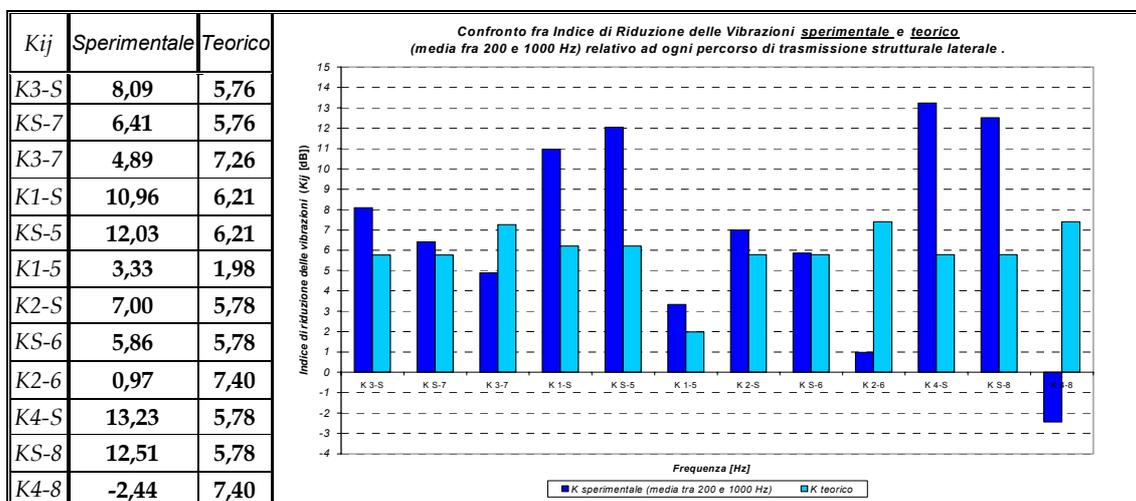
Figura 2: Confronto riassuntivo fra  $K_{ij}$  sperimentale e teorico per una parete in blocchi di laterizio spessi 18 cm, alleggeriti in pasta, con tre fori verticali riempiti in malta, intonacata con 1.5 cm di malta su ambo i lati.
