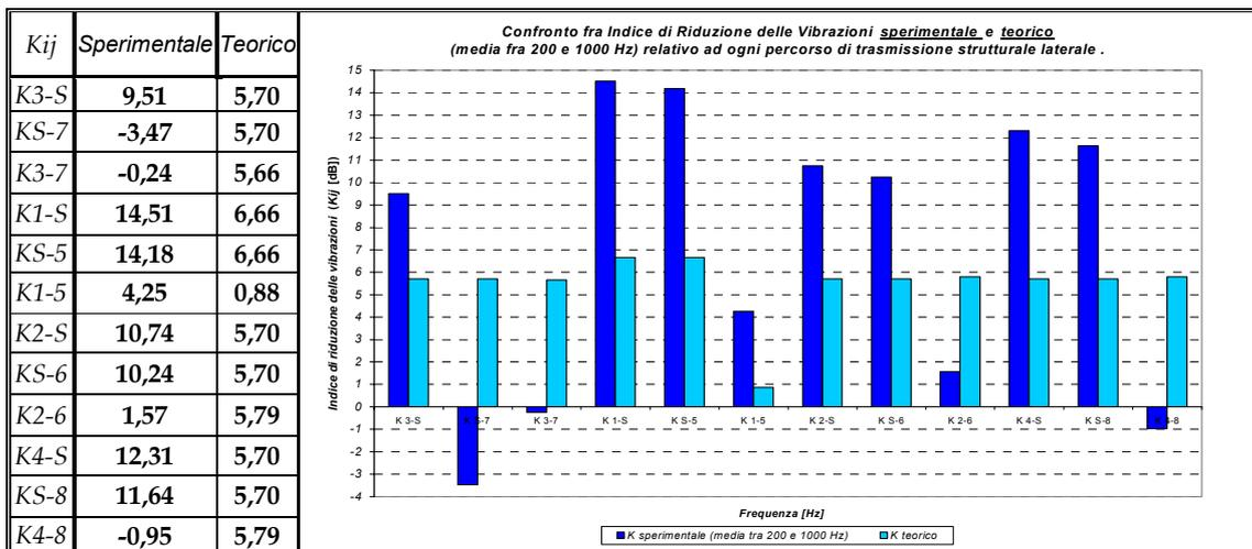
Figura 3: Confronto riassuntivo fra  $K_{ij}$  sperimentale e teorico per una parete doppia con uno strato in blocchi a T, intercapedine ed uno strato di mattoni forati spessi 8 cm, intonacata con 1.5 cm di malta.
