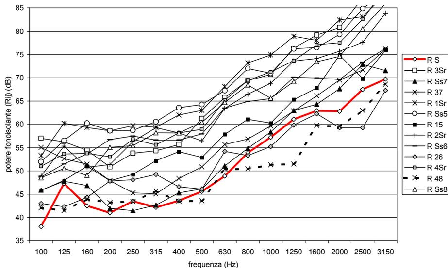
Figura 6: Valori del potere fonoisolante relativi alla trasmissione diretta (linea rossa) e laterale, per i diversi percorsi di trasmissione (parete doppia con uno strato in blocchi a T, intercapedine ed uno strato di mattoni forati spessi 8 cm, intonacata con 1.5 cm di malta).
