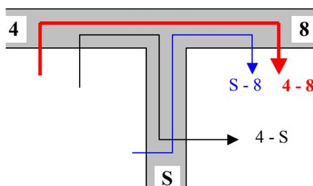
Figura 4: I tre percorsi strutturali nel caso del giunto tra la partizione ed il solaio di copertura.
