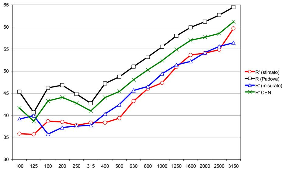
Figura 7: Dati sperimentali (in blu) e teorici (in rosso e verde) del potere fonoisolante apparente, al confronto con il valore del potere fonoisolante (in nero): parete realizzata con blocchi in laterizio da 18 cm, alleggeriti in pasta, con fori riempiti di malta, intonacata ambo i lati (spessore intonaco 1.5 cm).
