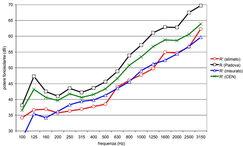
Figura 8: Dati sperimentali (in blu) e teorici (in rosso e verde) del potere fonoisolante apparente, al confronto con il valore del potere fonoisolante (in nero): parete realizzata con blocchi a "T" in laterizio alleggerito in pasta (25x16.5x17 cm), con tagli verticali, montati sfalsati ed intonaco sul lato esterno (spessore intonaco 1.5 cm); intercapedine da 3 cm; tramezze semipiene alleggerite in pasta (45x25x8 cm) ed intonaco sul lato esterno (spessore intonaco 1.5 cm).
