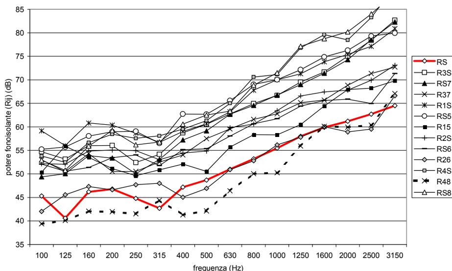
Figura 5: Valori del potere fonoisolante relativi alla trasmissione diretta (linea rossa) e laterale, per i diversi percorsi di trasmissione (parete in blocchi di laterizio spessi 18 cm, alleggeriti in pasta, con fori riempiti di malta, intonacata).
