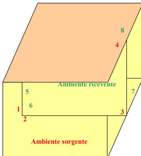
Figura A.1: Codificazione degli elementi strutturali laterali dei due ambienti adiacenti.
