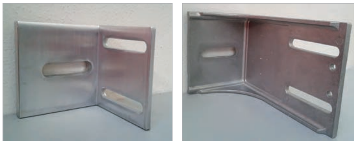
Figura 3.5 - Nell'immagine di sinistra una staffa in lega alluminio (ottenuta per estrusione e asolatura al banco) con oggetto massimo utile dal tamponamento rustico di 80 mm; a destra una staffa in lega di alluminio (ottenuta per pressofusione) con oggetto massimo utile dal tamponamento rustico di 160 mm, impiegabile in abbinamento a spessori d'isolante sino a 14 cm; le nervature di rinforzo sono rese necessarie dalla sua notevole snellezza
