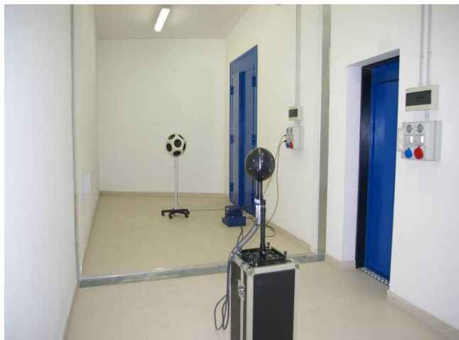
Figura 4 – Vista della camera riverberante con la sorgente sonora dodecaedrica posta sullo sfondo e in primo piano l'array microfonico sferico
