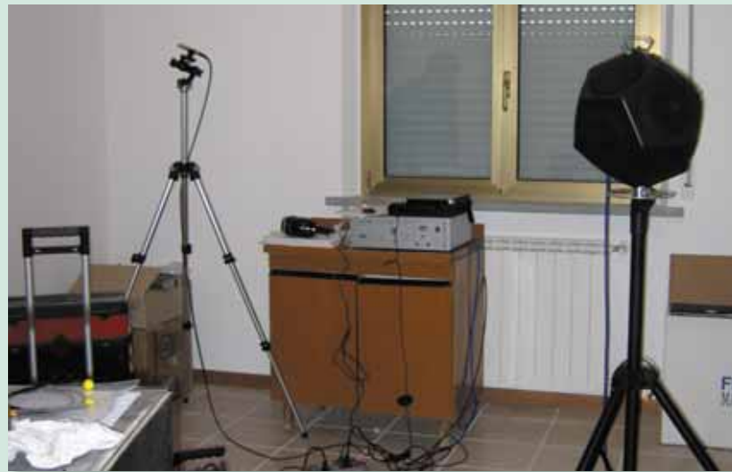
Figg. 3 e 4 - Fase di collaudo acustico di solaio di una struttura ospedaliera marchigiana da parte dei tecnici acustici di Igiestudio S.r.l. di Jesi. In evidenza il generatore normalizzato di calpestio, la sorgente rosa e diffusore dodecaedrico, microfono e strumentazione per la registrazione fonometrica.
