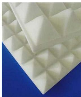
Infine, è importante la *forma* del materiale, in quanto può offrire una più estesa superficie di contatto con l'onda incidente, favorendo la dissipazione di una maggiore quantità di energia sonora. La soluzione più diffusa è quella in cui un lato del materiale è ricoperto da protuberanze a forma piramidale (come da figura).
