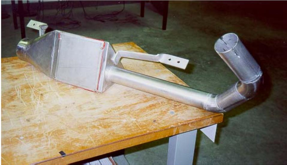
**Fig. 9:** *realizzazione finale della marmitta elettronica*
