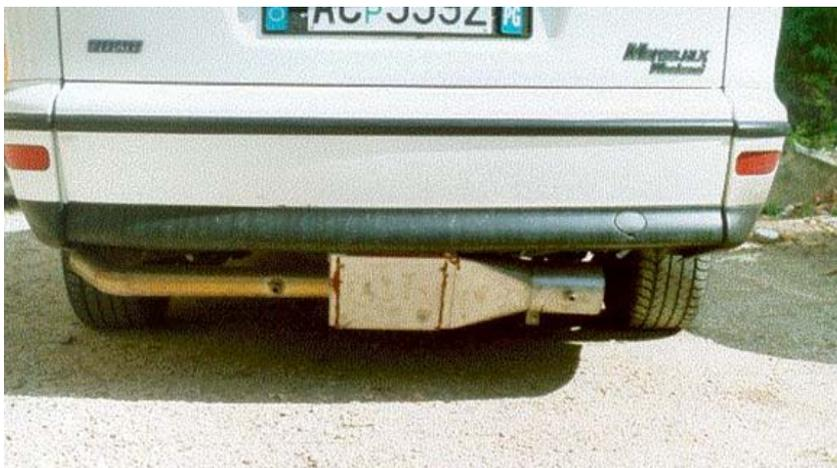
**Fig. 28:** marmitta elettronica installata sull'autovettura
