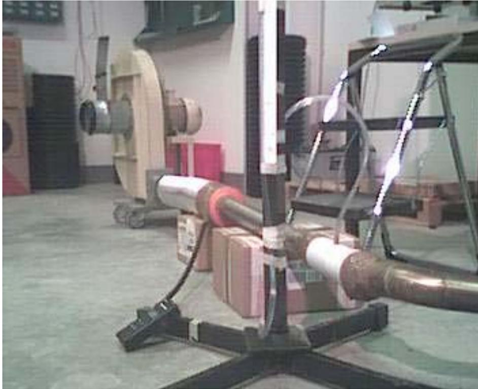
**Fig. 16:** *foto della strumentazione utilizzata nelle misure di pressione*
