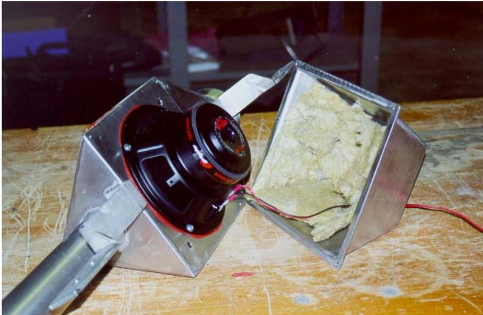
**Fig. 8:** *fasi di montaggio della marmitta elettronica*
