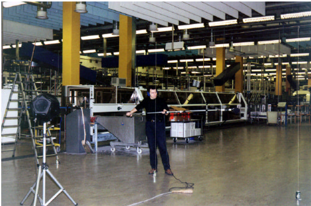
figura 1 : una zona dell'ambiente oggetto di studio. In primo piano è visibile una sorgente sonora omnidirezionale, utilizzata per eseguire alcune verifiche sperimentali.
