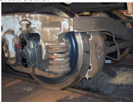
Figura 3.2. Foto di un carro merci riattrezzato con soles K. Questi vecchi carri merci risultano così silenziosi come le moderne carrozze passeggeri.
