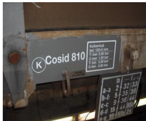
Figura 3.2. Foto di un carro merci riattrezzato con soles K. Questi vecchi carri merci risultano così silenziosi come le moderne carrozze passeggeri.
