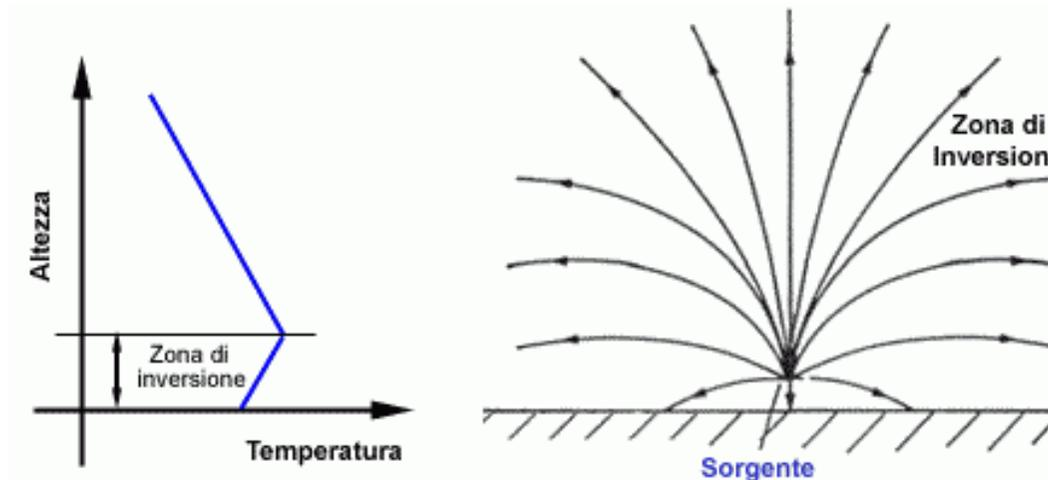
Figura 2: Andamento della temperatura e dei raggi sonori in caso di inversione termica
