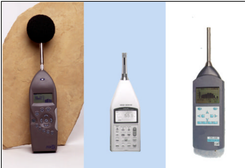
figura 2 : alcuni fonometri analizzatori dell'ultima generazione. Da sinistra verso destra : Larson&Davis 824, Ono Sokki LA 5110 e CEL 593.
