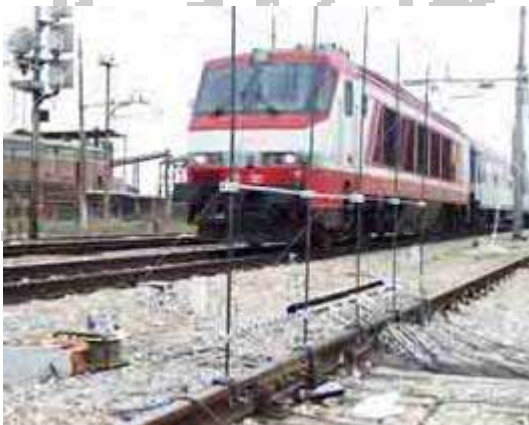
Figura 1: HipertTrack 2001 - treno test e array microfonico
