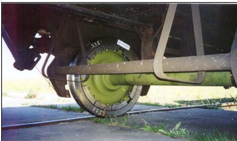
Figura 7. Assorbitori di vibrazioni installati su una ruota. Corrispondono ai dispositivi rettangolari grigi che vediamo tutt'attorno la ruota stessa.
