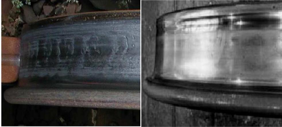
Figura 3. Effetti dell'azione dei freni sulla ruota. A sinistra l'effetto di un freno a ceppi di ghisa. A destra l'effetto di un freno di materiale composito. Si notino le diverse asperità che si vengono a creare.
