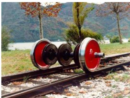
Figura 4. Ruote silenziate dopo l'applicazione del rivestimento visco-elastico.
