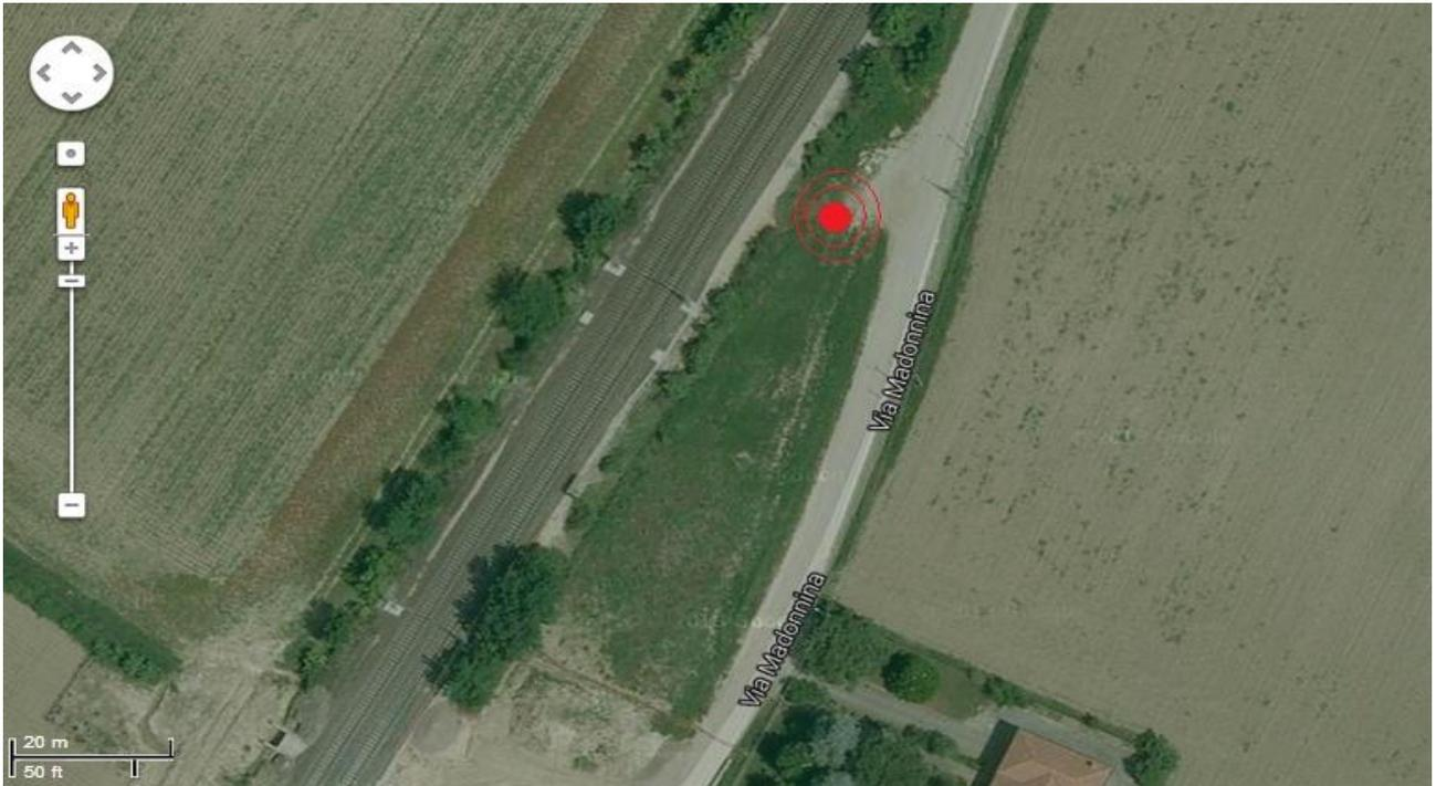
La sorgente è costituita da una doppia linea percorsa da tutte le categorie di treno, le quali, essendo in rettilineo e non nei pressi di stazioni, hanno la possibilità di raggiungere la velocità preferita. La pendenza è quasi nulla, e le due linee vengono utilizzate indifferentemente sia per quanto riguarda il senso di marcia che per quanto riguarda le categorie ammesse. Le linee non presentano ad una prima analisi alcuna differenza di sorta.
