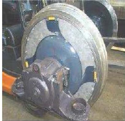
Figura 5. Ruota silenziata con assorbitori in acciaio.
