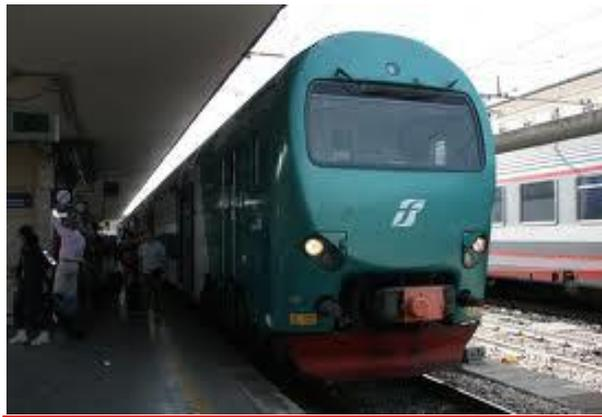
La tipologia di locomotiva ALe 506 e 426 viene oggi impiegata da Trenitalia per espletare il servizio TAF (Treno ad Alta Frenquenza), un treno dalla composizione fissa con carrozze a due piani e trainato da entrambe le estremità da due locomotori elettrici. Attualmente il TAF viene impiegato per il trasporto locale in alcune tratte locali e, in Veneto e Liguria per tratte regionali (viene impiegato negli altri casi in aree suburbane o come treno di collegamento verso aeroporti).
