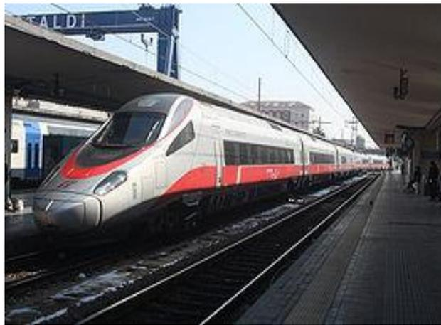
Il treno ETR 600 rappresenta un esempio di “treno pendolante”, ovvero in grado di inclinare la cassa in corrispondenza delle curve. Ciò gli consente di raggiungere velocità considerevoli mantenendo un alto valore di comfort.
