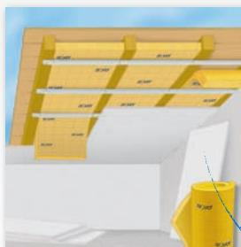
**Copertura a falda (su locale abitato):** struttura in legno isolata all'introdosso tra i travetti. Isolamento con feltro IBR K.
