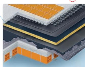
**Copertura piana pedonabile:** struttura in latero-cemento da 18+4 cm + massetto + pavimentazione. Isolamento con pannello BAC 2000 HP.
