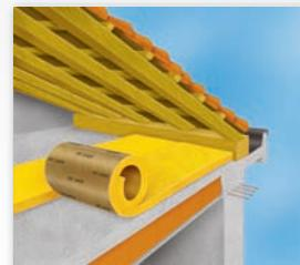
**Copertura a falda (sottotetto non abitabile):** struttura con solaio non praticabile. Isolamento con feltro IBR K.
