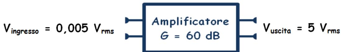
Dovendo definire il guadagno ( $G$ ) partendo dalla misura del segnale di ingresso ( $V_{in}$ ) e del segnale di uscita ( $V_{out}$ ) procederemo nel seguente modo:
