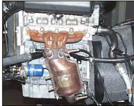
Figura 1: Parte “calda” del sistema di scarico (con collettore in ghisa)
