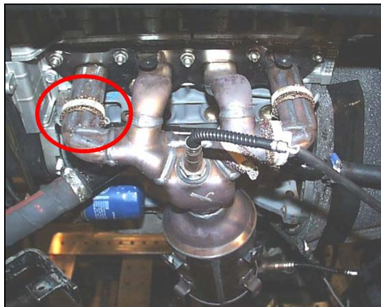
Figura 7: Collettore in acciaio con wired meshes
