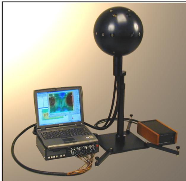
*Figura 5 – Sistema completo per misure simultanee in tutte le direzioni*
