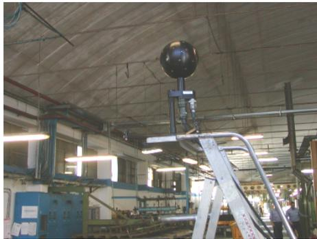
*Figura 7: il trasduttore montato su una scala all'interno del capannone*
